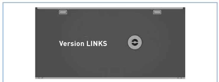
Bild 3: Position Kondensatanschluss Geräteversion LINKS
