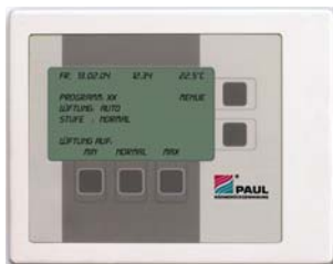
Komfort-Bedienteil für Automatik-Steuerung (LxBxT in mm: 158x125x32) Kabel: IYSTY 2x2x0,6, max. 15 m, bauseits
