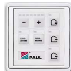
Folientastatur für manuelle Steuerung (LxBxT in mm: 80x80x12) Kabel: IYSTY 2x2x0,6, max. 15 m, bauseits
